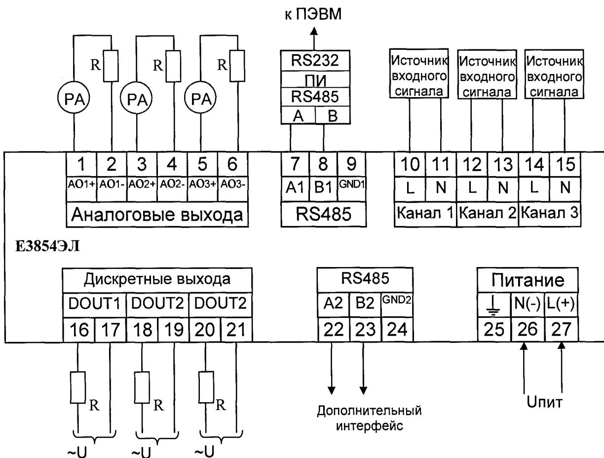
Рисунок А.1 – Схема подключения преобразователя E3854ЭЛ в однофазном исполнении
