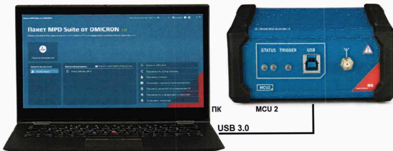
Рисунок 6 – Подключение ПК к контроллеру MCU 2 через USB 3.0
