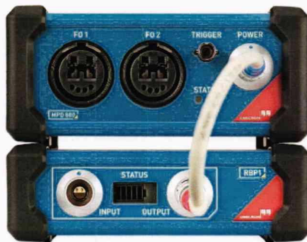
Рисунок 12 – Подключение аккумуляторного блока RBP1 к устройству сбора данных ЧР MPD 800
