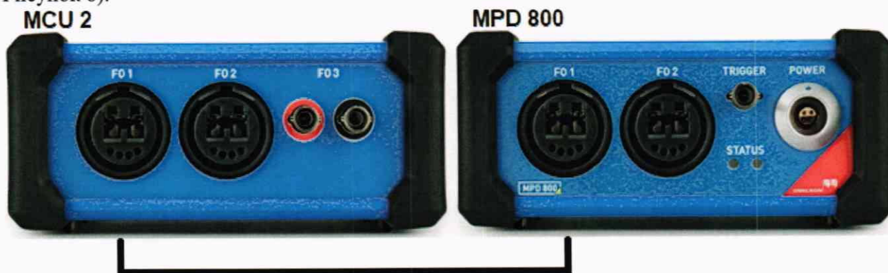
Рисунок 8 – Подключение устройства сбора данных ЧР MPD 800 к контроллеру MCU 2
