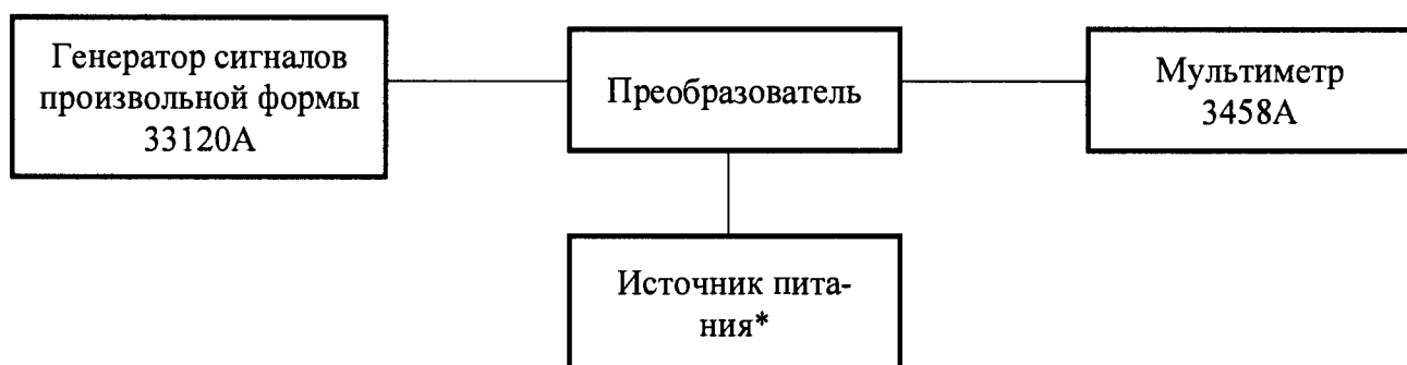
Рисунок 2 – Структурная схема определения погрешности преобразования частоты переменного тока
