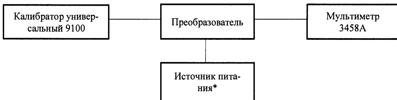
Рисунок 1 – Структурная схема определения погрешности преобразования напряжения постоянного тока, напряжения переменного тока, силы постоянного тока от 0 до 20 А, силы переменного тока, электрического сопротивления, термопары, термопреобразователя сопротивления
