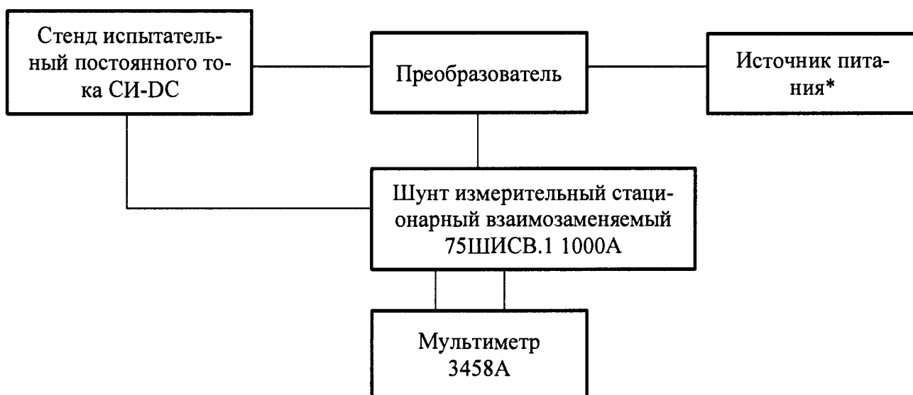
Рисунок 3 – Структурная схема определения погрешности преобразования силы постоянного тока от 20 до 60 А
