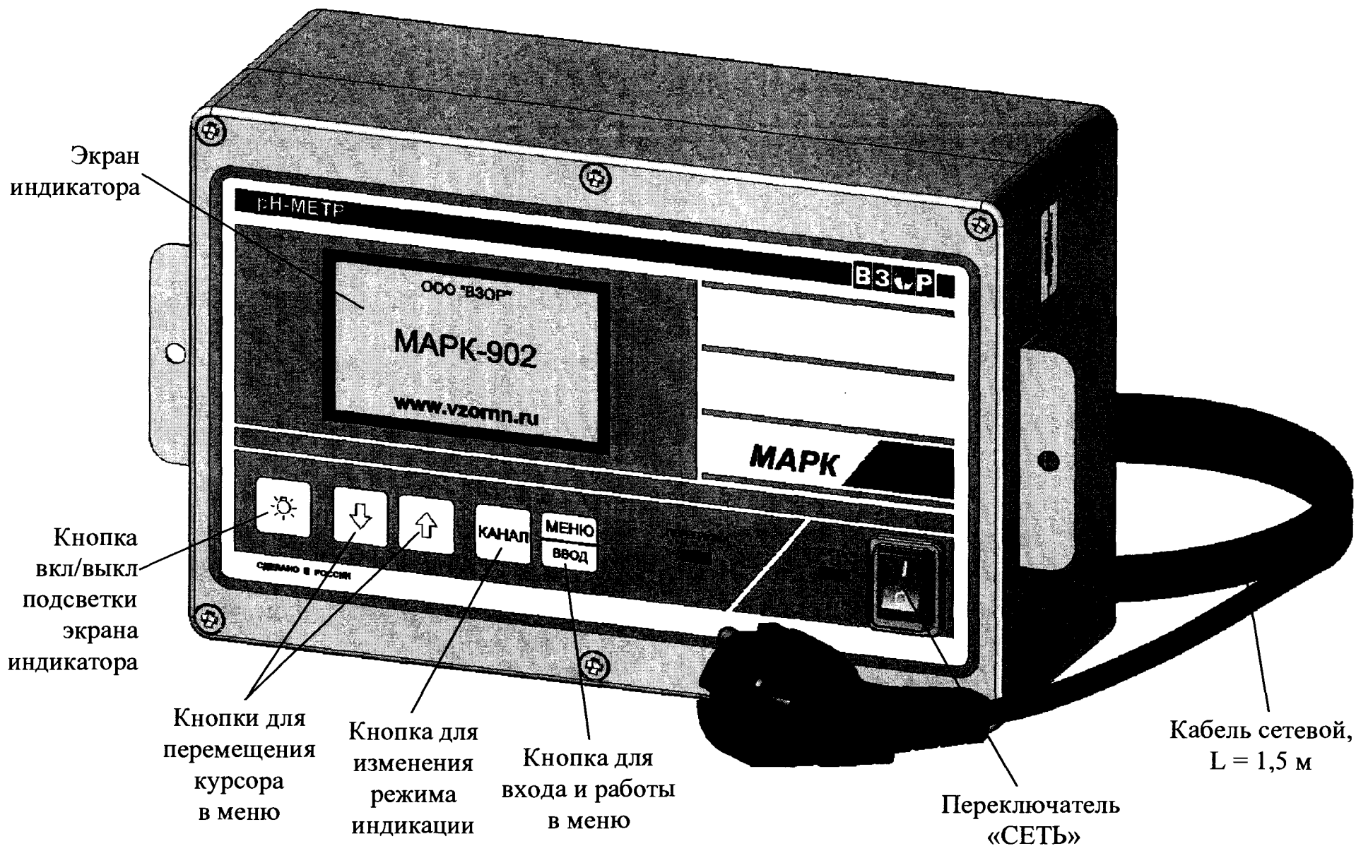
Рисунок 1.4 – Блок преобразовательный щитового исполнения (вид спереди)
