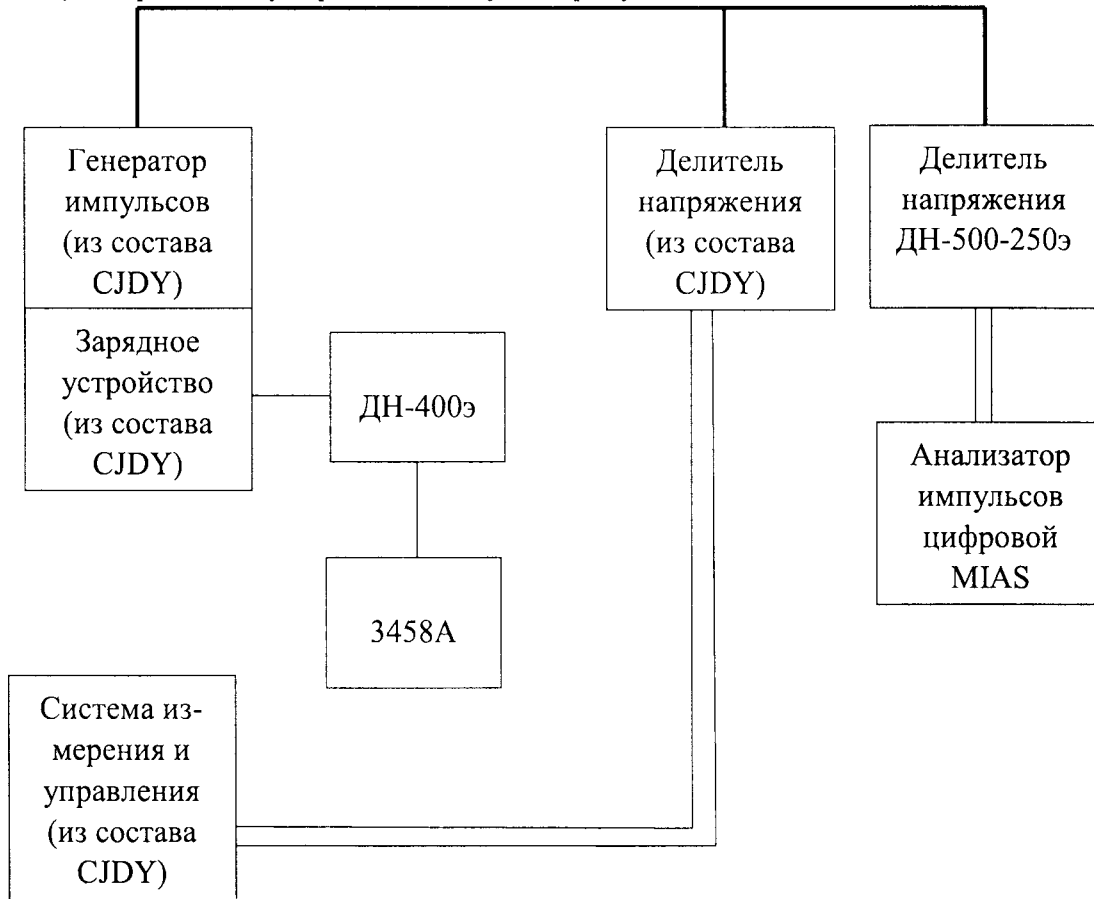
Рисунок 3 – Структурная схема проверки коэффициента полезного действия при воспроизведении стандартизованных грозовые (коммутационных) импульсов напряжения
