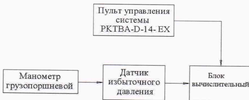
Рисунок 1 – Схема поверки каналов измерений избыточного давления комплектным методом
