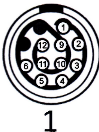
Рисунок 1 – Схема разъема ВТП на электронном блоке дефектоскопа
