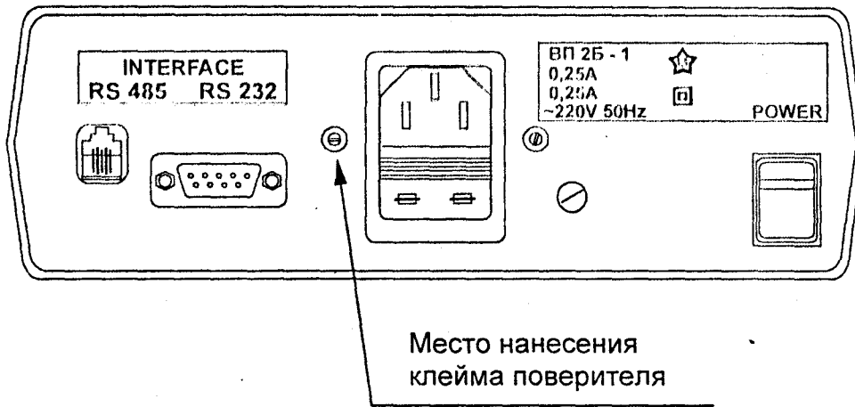
Рисунок В.1 – Место нанесения клейма поверителя на вольтметре В7-68
