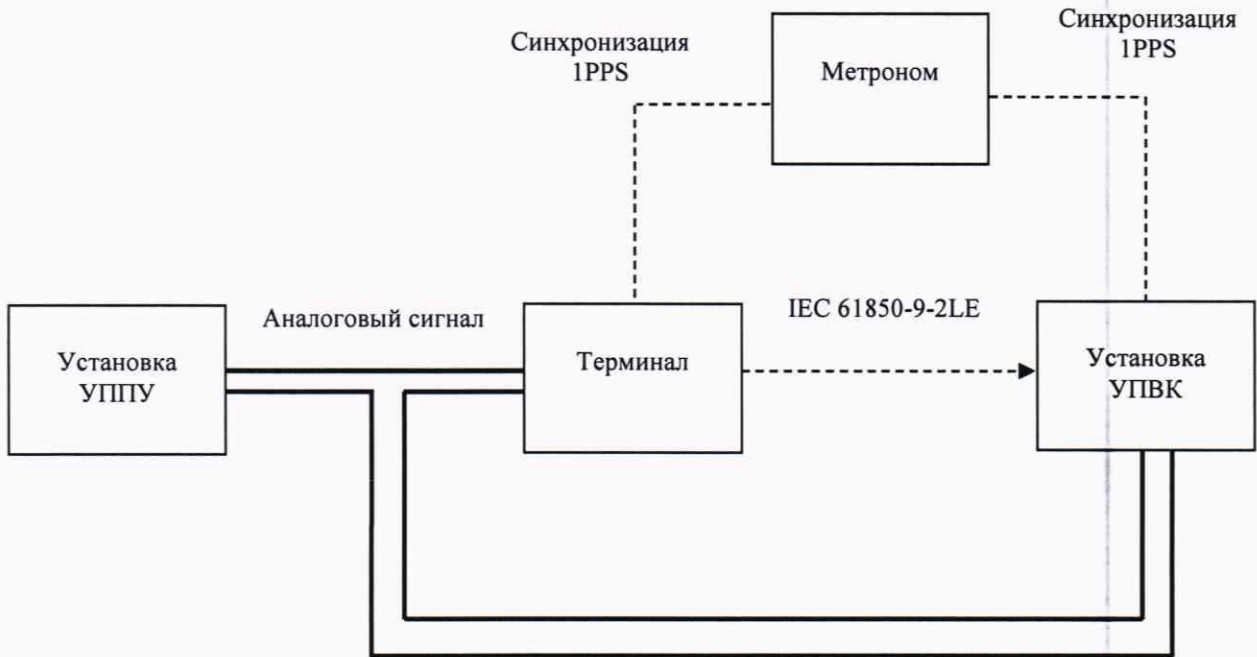
Рисунок А.2 – Структурная схема определения основных приведенных к номинальному значению погрешностей преобразований среднеквадратических значений силы переменного тока (для испытательных сигналов до 10 А)
