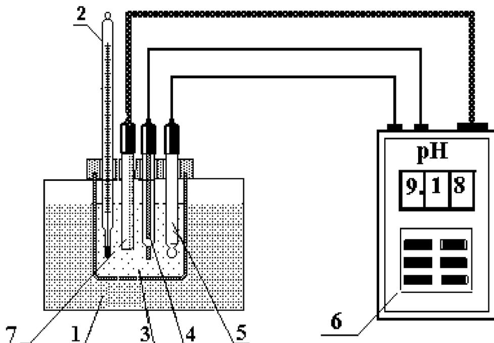
1 – термостат водяной; 2 – термометр ртутный стеклянный лабораторный; 3 – стакан с буферным раствором - рабочим эталоном pH; 4 – электрод сравнения (вспомогательный электрод) из состава прибора; 5 – измерительный (стеклянный) электрод из состава прибора; 6 – измерительный преобразователь из состава прибора; 7 – термокомпенсатор с соединительным кабелем.
