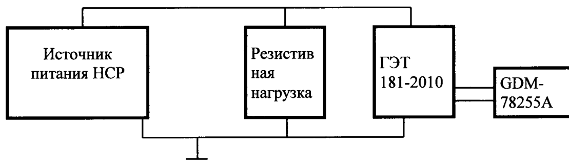
Рисунок 4 – Схема определения погрешности измерения напряжения при нагрузке, свыше 1000 В
