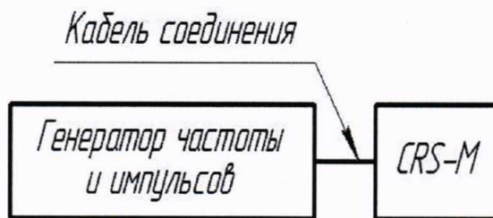
Рисунок 4 - Схема проверки системы по подсчёту количества импульсов
