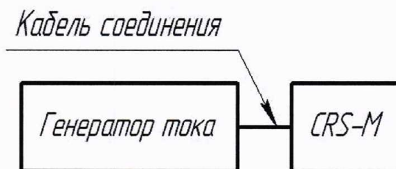
Рисунок 3 - Схема поверки системы по токовым входам
