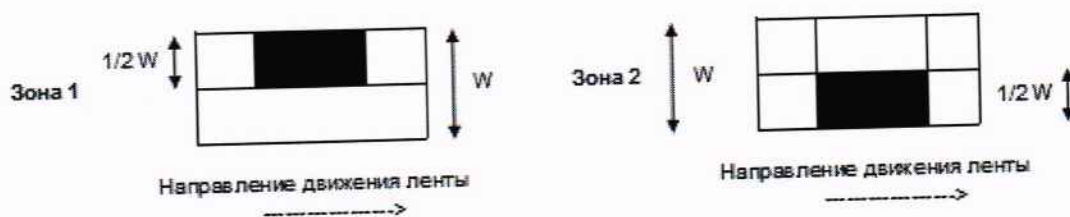
Рисунок 1 — Расположение испытательных нагрузок для СИ, осуществляющих взвешивание динамически
