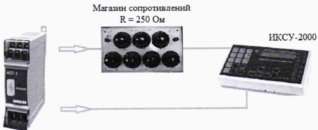
Рисунок Б.2 - Схема подключения выходных сигналов постоянного тока НПТ-1
