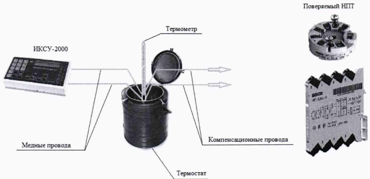
Рисунок А.2 - Схема подключения при проверке входных сигналов от термоэлектрических преобразователей
