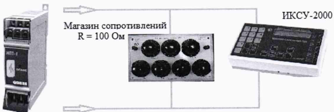
Рисунок Б.3 - Схема подключения выходных сигналов напряжения постоянного тока НПТ-1
