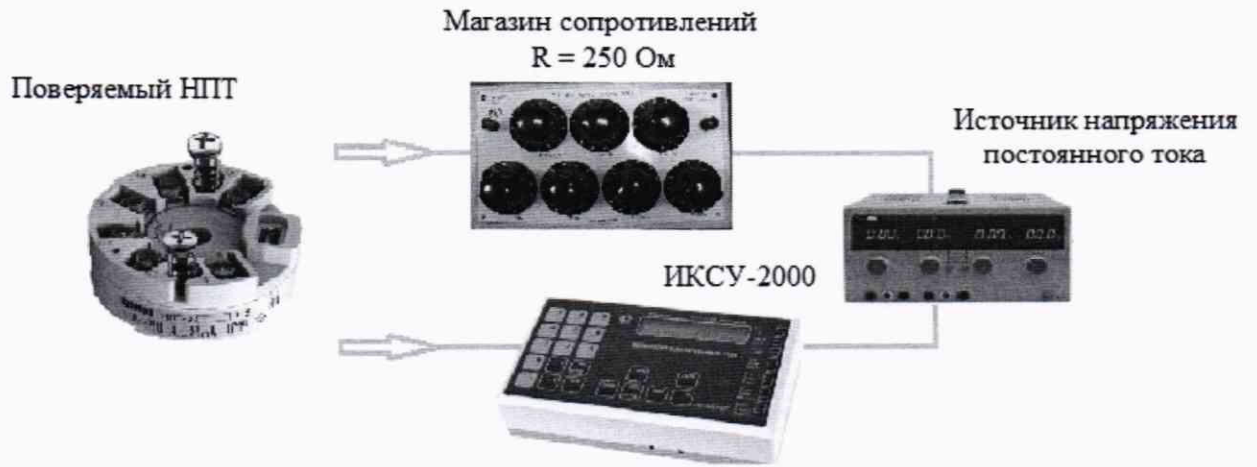
Рисунок Б.4 - Схема подключения выходных сигналов постоянного тока НПТ-2 и НПТ-3
