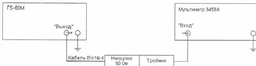
Рисунок 9 - Схема соединений для определения диапазона изменения уровня напряжения, дискретности и погрешности установки базового смещения
