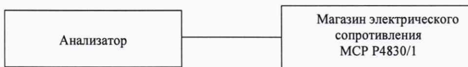
Рисунок 3 – Схема подключения при измерении электрического сопротивления переменному току
