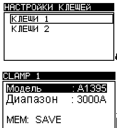
Рисунок 4.5: Настройка измерительных входов токовых клещей
