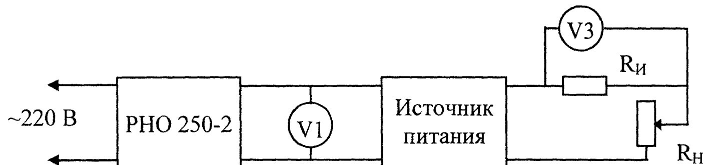
Рис. 6. Структурная схема измерения пульсации выходного тока в режиме стабилизации тока.
