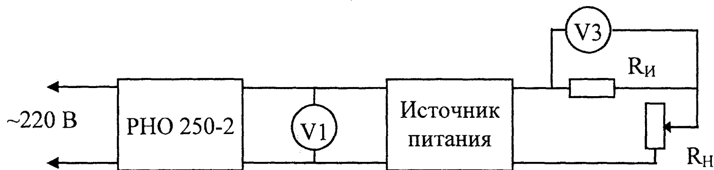
Рис. 5. Структурная схема измерения нестабильности выходного тока от изменения напряжения питающей сети и напряжения на нагрузке в режиме стабилизации тока.
