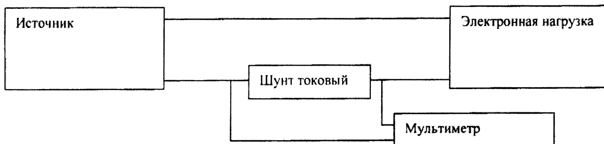
Рисунок 2 – Структурная схема определения абсолютной погрешности воспроизведений силы постоянного тока
