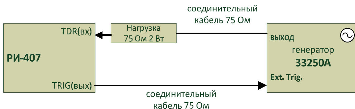
Рисунок 9-1. Проверка диапазона измерения расстояния
