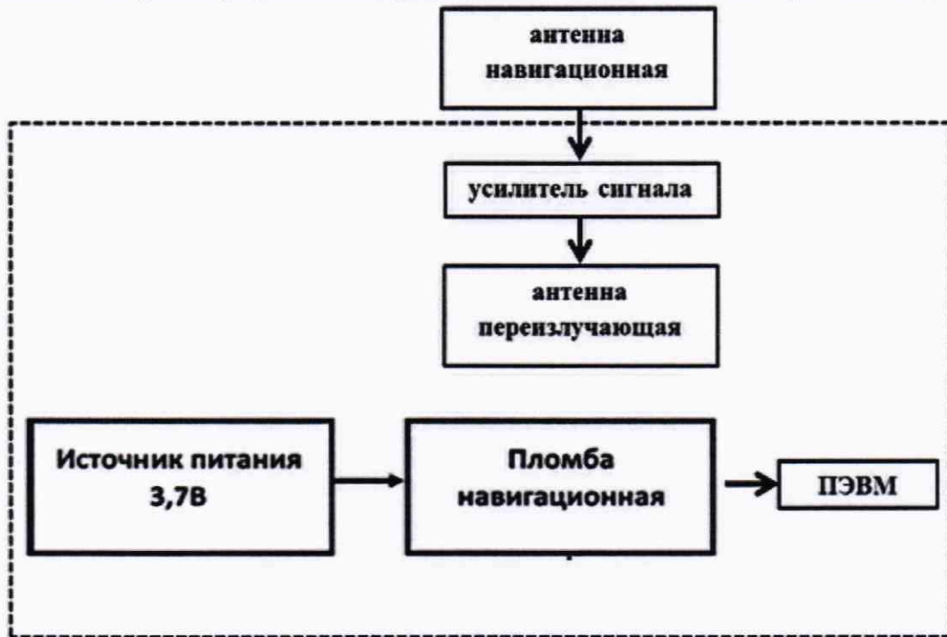
Рисунок 5 – Схема проведения измерений при определении погрешности определения координат при первичной поверке
