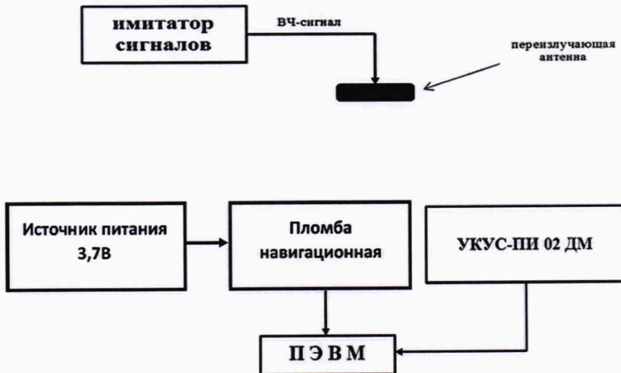
Рисунок 4 – Схема проведения измерений при периодической поверке устройств
