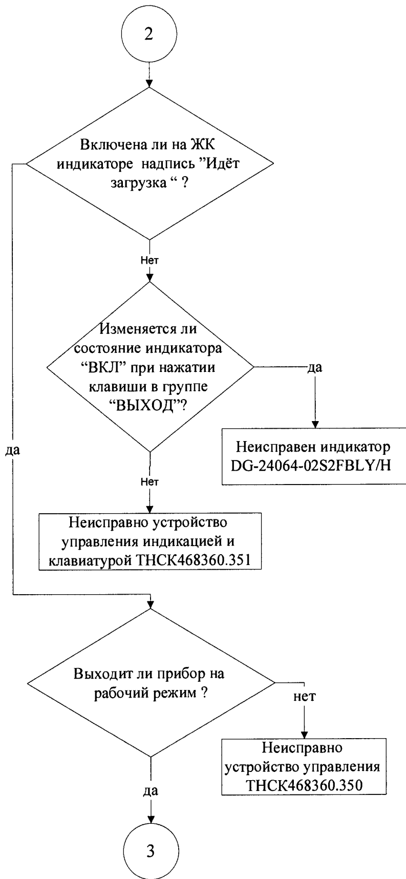
Рисунок 9. в– Схема алгоритма диагностирования по поиску неисправностей генератора сигналов высокочастотного Г4-227
