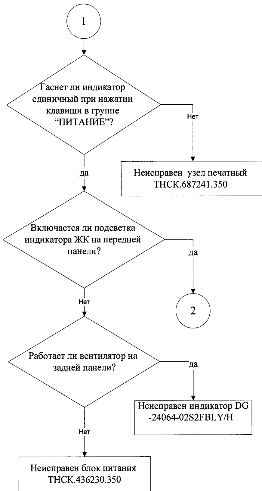
Рисунок 9 б– Схема алгоритма диагностирования по поиску неисправностей генератора сигналов высокочастотного Г4-227
