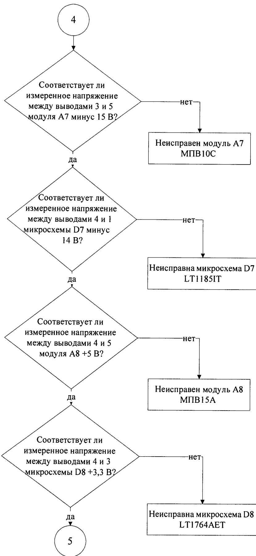
Рисунок 9.3 д – Схема алгоритма диагностирования по поиску неисправностей блока питания ТНСК436230.350
