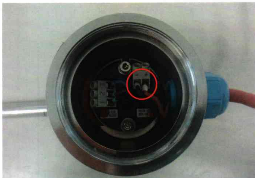
Рисунок 1. Схема подключения калибратора к токовому выходу преобразователя.
