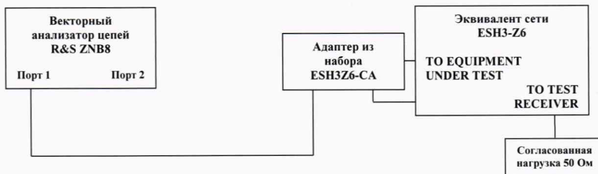
Рисунок 3 – Измерение модуля полного входного сопротивления
