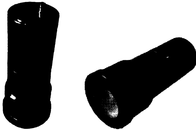
Рисунок 2.3 Блоки детектирования бета и альфа - излучения
