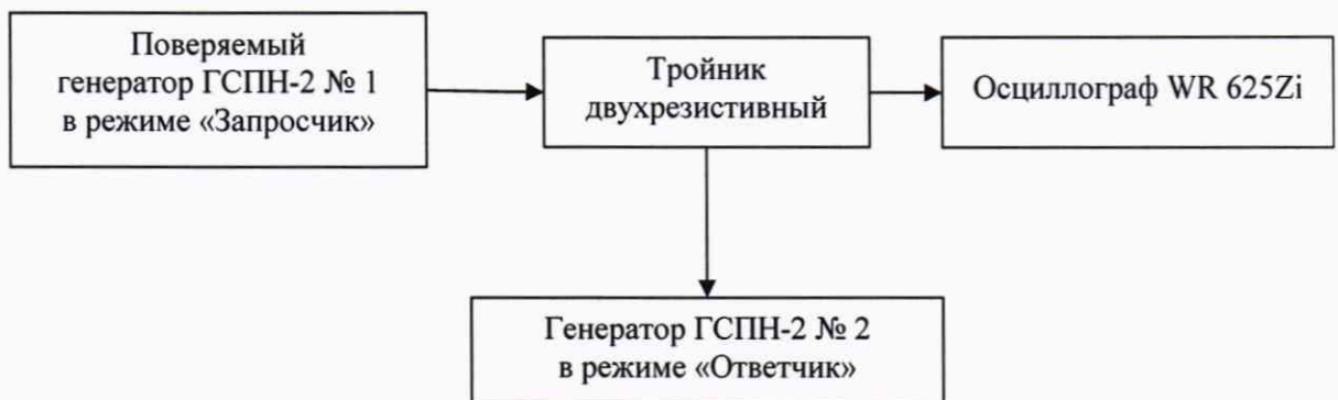
Рисунок 4 – Схема измерений для определения абсолютной погрешности измерений задержки сигналов запроса дальности в режиме «Запросчик»
