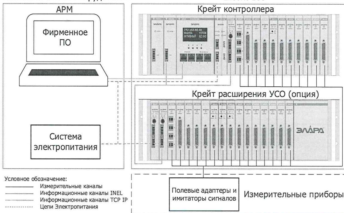
Рисунок 1 – Структурная схема стенда для поверки ИК
