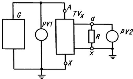
*G* — источник высокого напряжения; *TV<sub>x</sub>* — проверяемый трансформатор; *PV1*, *PV2* — образцовые вольтметры; *R* — нагрузочное устройство
