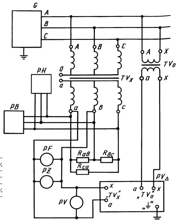
$G$  — источник трехфазной системы напряжений;  $TV_x$  — поверяемый трансформатор;  $TV_o$  — образцовый трансформатор;  $PH$  — фазоуказатель;  $PB$  — измеритель несимметрии;  $PZ$  — измеритель нелинейных искажений;  $PF$  — частотомер;  $PV$  — вольтметр с пределом измерений 150 В (подключается в случае отсутствия встроенного вольтметра в приборе сравнения);  $R_{ab}$ ,  $R_{bc}$ ,  $R_{ca}$  — нагрузочные устройства поверяемого трансформатора;  $PV_{\Delta}$  — прибор сравнения
