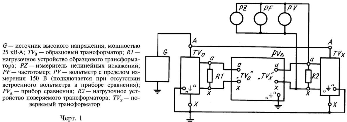
образцовый трансформатор подключают к прибору сравнения проводниками сопротивлением не более 0,015 Ом при проверке трансформаторов классов точности 0,1, 0,2 и 0,06 Ом — при проверке трансформаторов класса точности 0,5 и менее точных;
