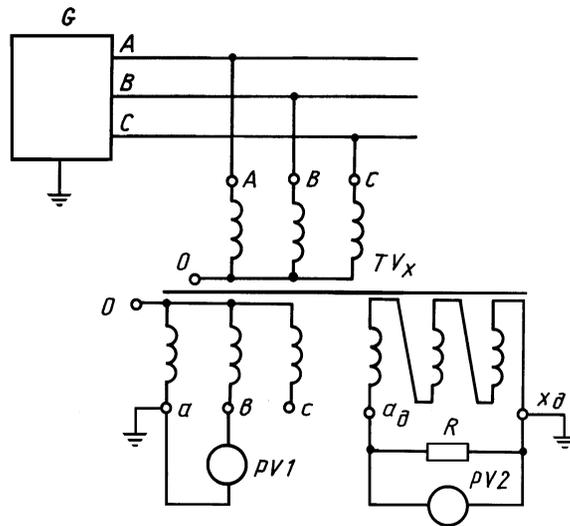
$TV_x$  — проверяемый трансформатор;  $G$  — источник трехфазной системы напряжений;  $PV1$  — вольтметр с пределом измерения 150 В;  $PV2$  — вольтметр с пределом измерения 5–7 В;  $R$  — нагрузочное устройство дополнительной обмотки
