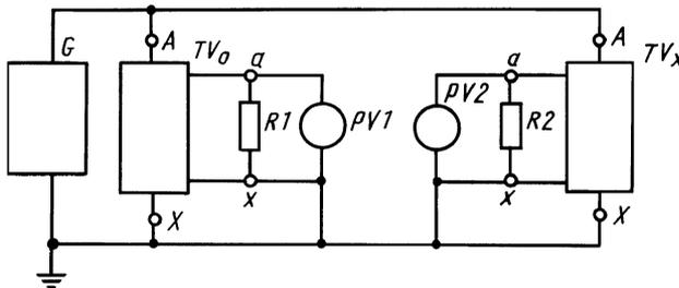
*G* — источник высокого напряжения; *TV<sub>o</sub>* — образцовый трансформатор; *TV<sub>x</sub>* — проверяемый трансформатор; *R1*, *R2* — нагрузочные устройства образцового и проверяемого трансформаторов; *PV1*, *PV2* — образцовые вольтметры
