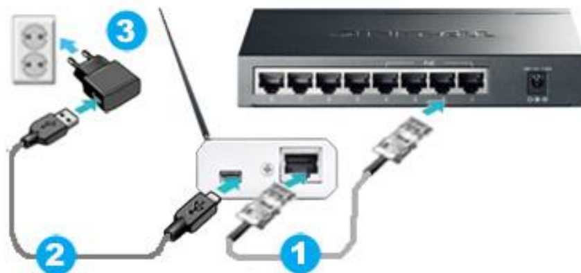
Рисунок 2.1 – Подключение менеджера WST-EMT к проводному Интернету
