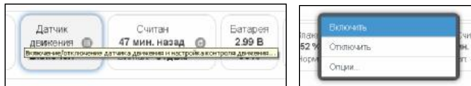
Рисунок 2.65 – Кнопка [Датчик движения] на панели тегов WST-13 и WST-Pro и меню индивидуального включения/отключения датчика движения.
