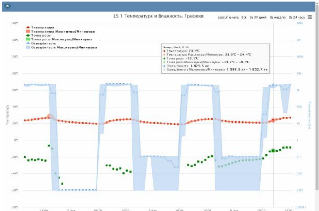
Рисунок 2.117 – Окно “Температура и Влажность. Графики” с часовыми максимумами/минимумами для тегов WST-Pro-ALS.
