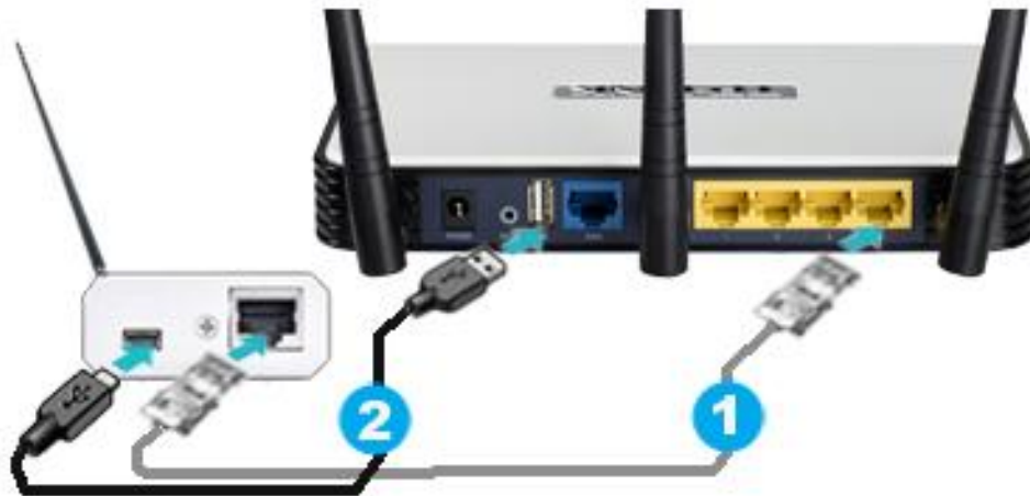
Рисунок 2.4 – Подключение менеджера WST-EMT к беспроводному Wi-Fi-Интернету
