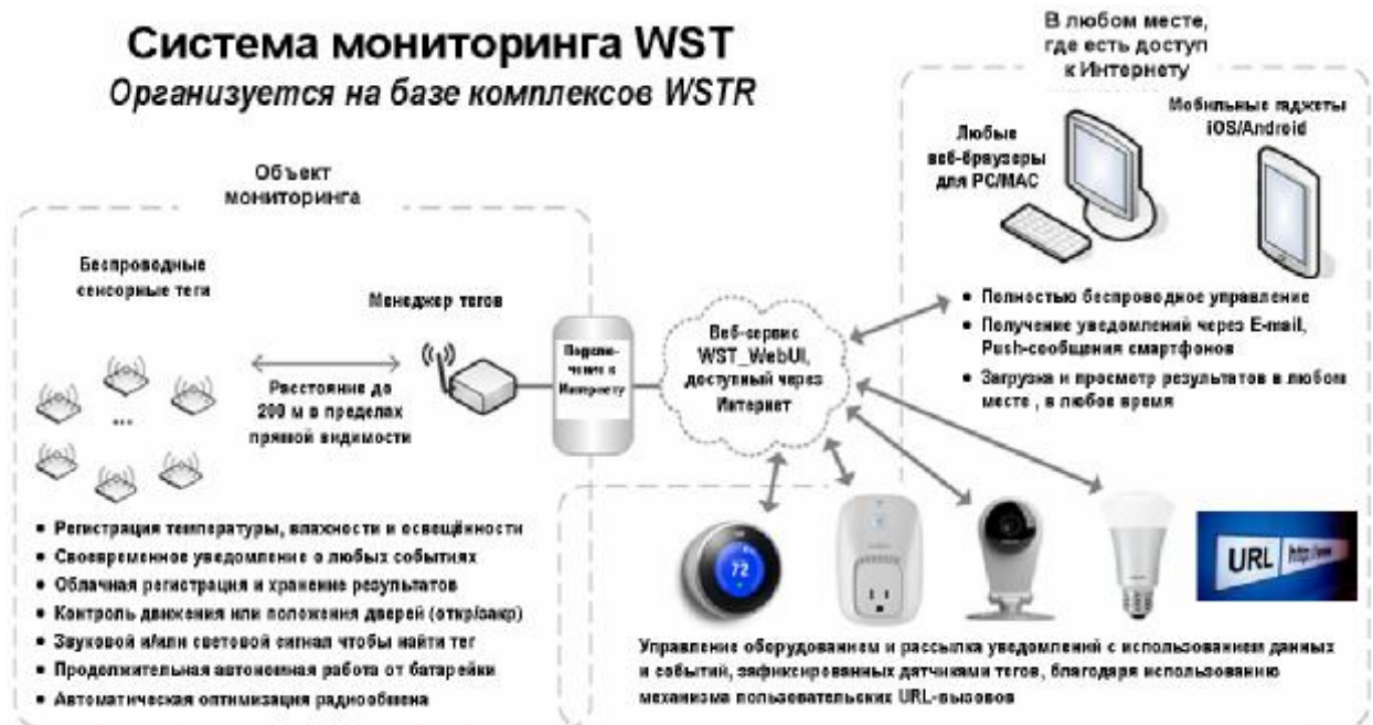
Рисунок 1.1 – Функциональная схема применения комплекса WSTR для организации распределённой системы мониторинга WST
