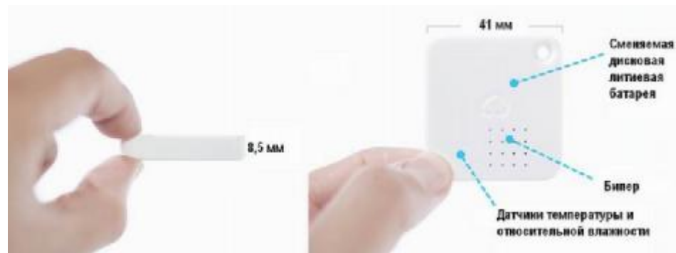
Рисунок 1.2 - Внешний вид и размеры тегов комплекса WSTR
