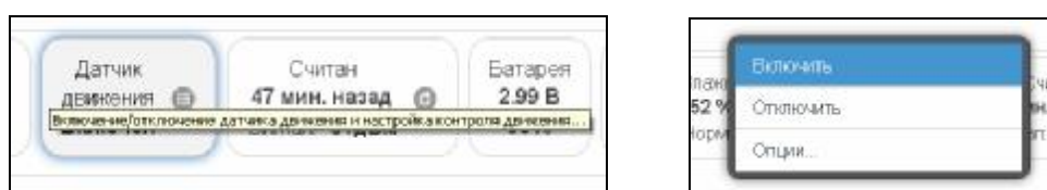
Рисунок 2.78 – Кнопка [Датчик движения] на панели тегов WST-Pro-ALS и меню индивидуального включения/отключения датчика движения.
