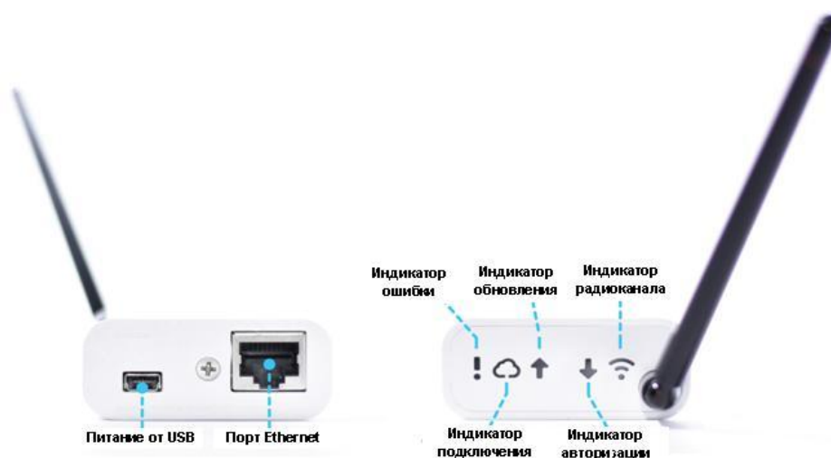
Рисунок 1.5 – Внешний вид и назначение разъёмов и светодиодных индикаторов менеджера тегов WST-ETM
