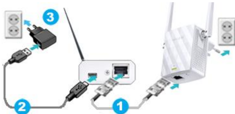
Рисунок 2.5 – Подключение менеджера WST-EMT к Интернету через беспроводной Wi-Fi-репитер
