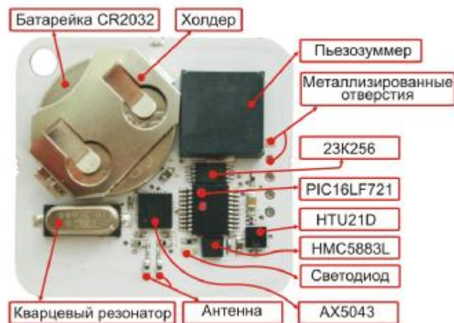
Рисунок 1.4 – Размещение элементов электронной схемы на печатной плате тега WST-#
