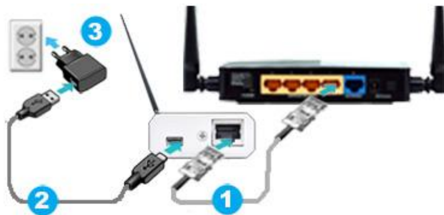
Рисунок 2.3 – Подключение менеджера WST-EMT к беспроводному Wi-Fi-Интернету
