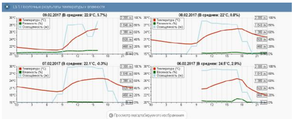
Рисунок 2.119 – Окно посуточных графиков температуры и влажности для тегов WST-Pro-ALS.
