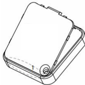
Рисунок 2.11 – Закрытие корпуса тега путём защёлкивания основания на крышке
