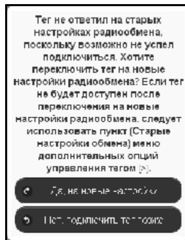
Рисунок 2.125 – Служебное окно, генерируемое при отсутствии ответа тега после его переключения на старые настройки радиобмена.
