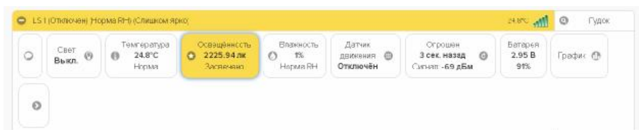
Рисунок 2.63 – Строка тега и кнопка [Освещённость] на панели тега при засветки тега.
