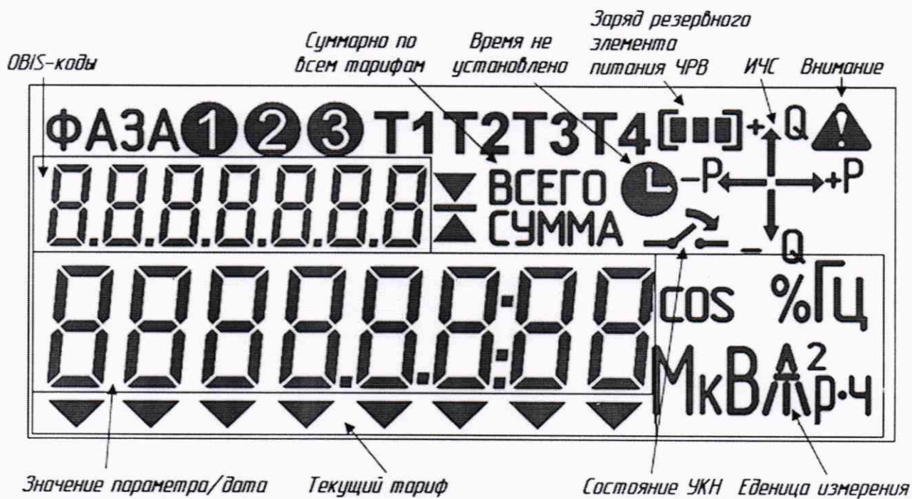
Рисунок Ж.1 – Расположение полей дисплея счетчика
