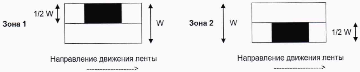
Рисунок 1 — Расположение испытательных нагрузок при оценке погрешности в режиме динамического взвешивания объектов измерений при их нецентрированном положении при движении по конвейерной ленте
