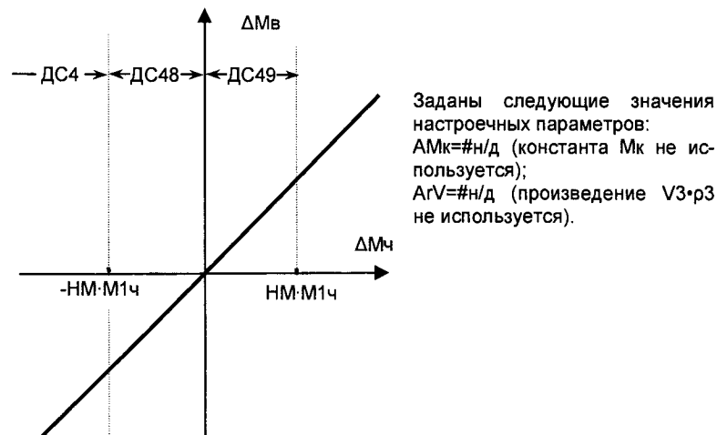
Рисунок 7.4 – Контроль разности часовых масс \Delta M_{ч} = (M1_{ч} - M2_{ч})
