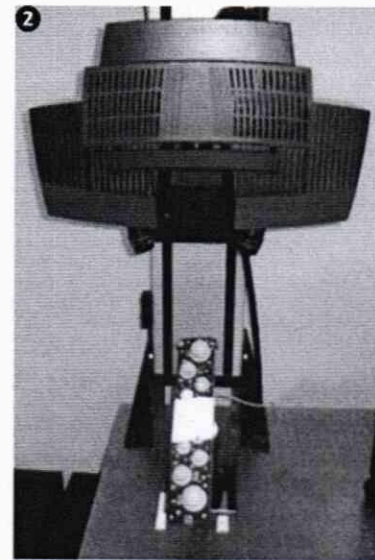
Рисунок 3 – Взаимное расположение меры относительно системы при измерении меры в горизонтальном положении ближе к левой сфере (1 – система наклонена под углом 45^\circ , 2 – система наклонена под углом 30^\circ )
