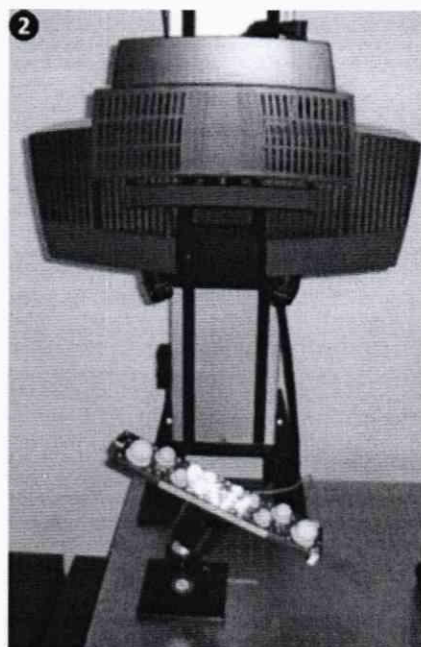
Рисунок 4 – Взаимное расположение меры относительно системы при второй серии измерений
