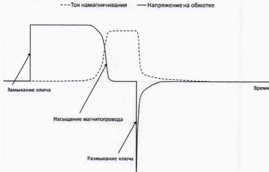
Рисунок 2 – Характерный вид зависимости напряжения на испытуемой обмотке и тока намагничивания от времени
