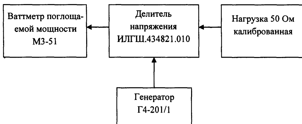
Рисунок А.1 – Структурная схема проверки делителя напряжения ИЛГШ.434821.010
