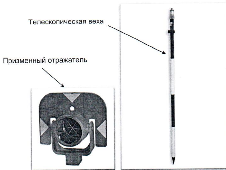
Рисунок А.1 – Веха телескопическая с призмным отражателем
