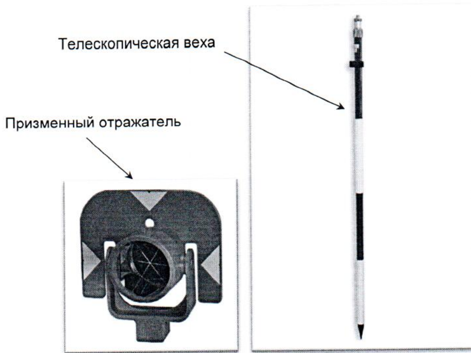
Рисунок А.1 – Веха телескопическая с призмным отражателем
