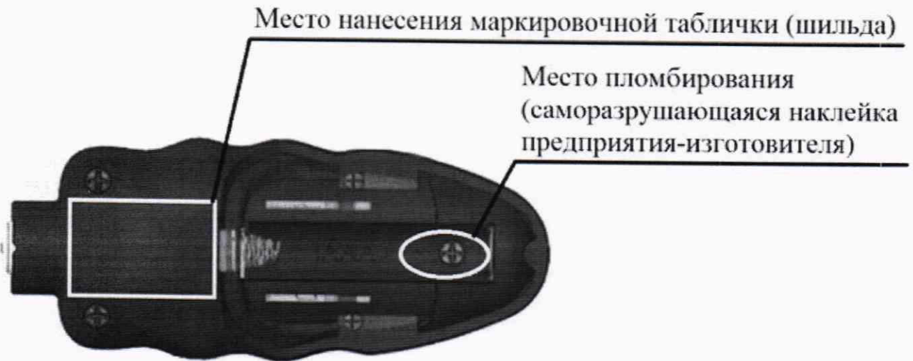
Рисунок А.1 – Схема пломбировки от несанкционированного доступа
