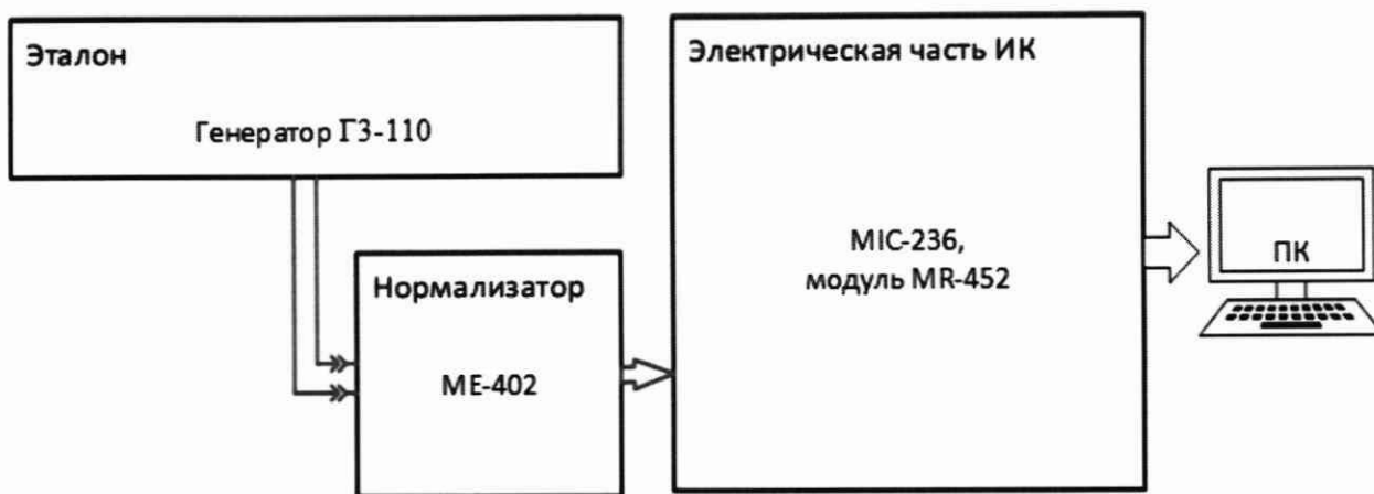
Рисунок 15 – Схема поверки ИК частоты переменного тока, соответствующей частоте вращения ротора
