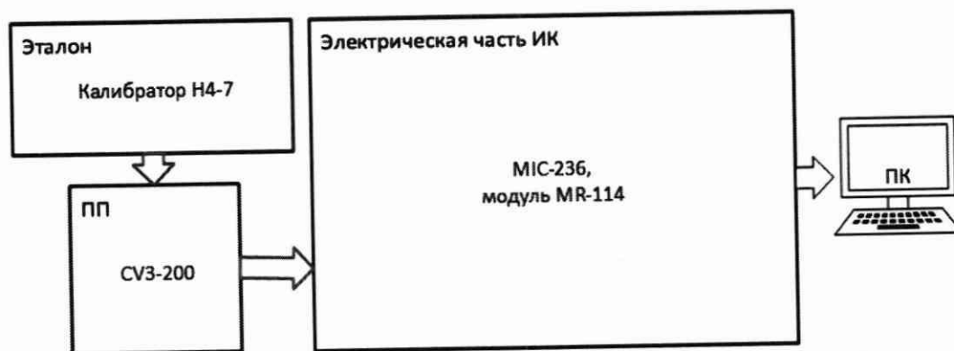
Рисунок 11 – Схема поверки ИК напряжения переменного тока генератора комплектным способом
