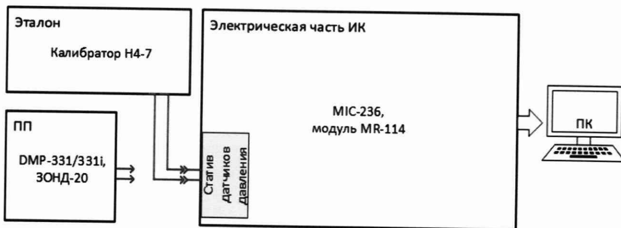
Рисунок 5 – Схема поверки ИК абсолютных, избыточных и разности давлений газообразных и жидких сред поэлементным способом
