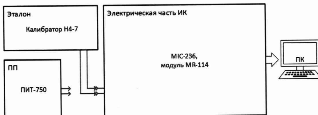
Рисунок 12 – Схема поверки электрической части ИК силы переменного тока
