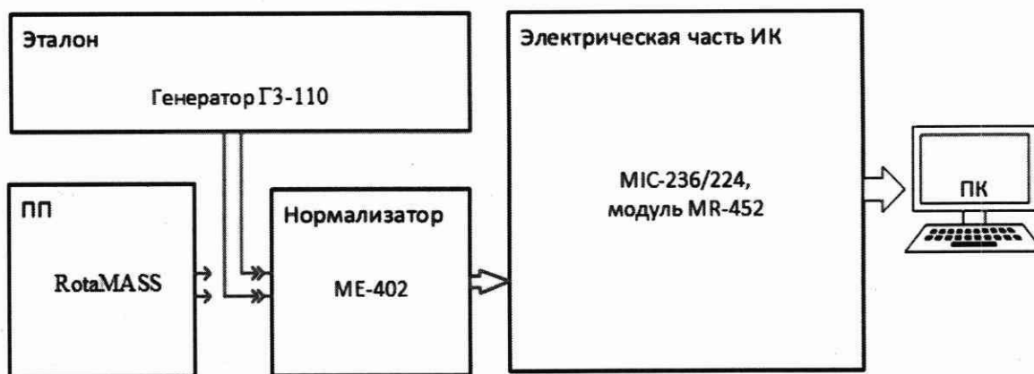
Рисунок 8 – Схема поверки ИК объемного расхода (прокачки) жидкостей
