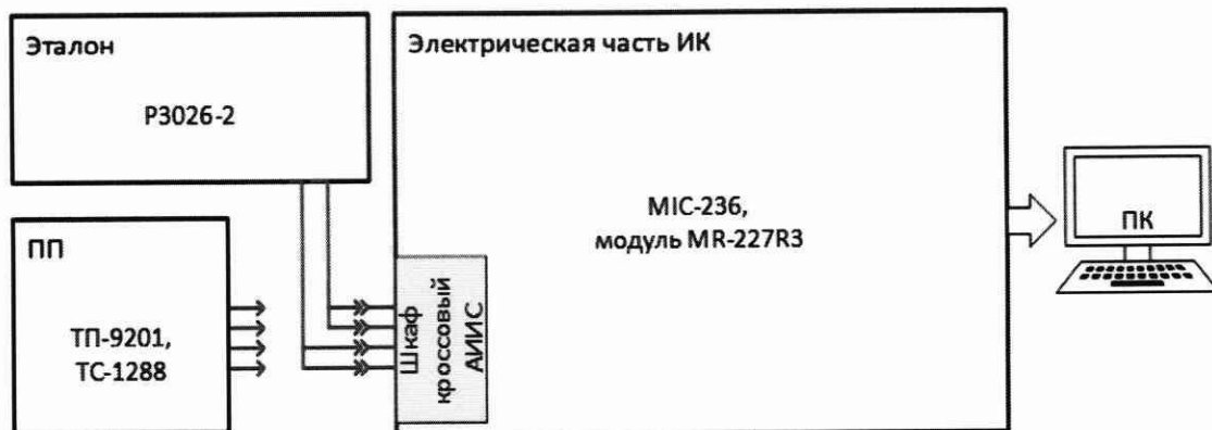
Рисунок 2 – Схема поверки ИК температуры жидких и газообразных сред (с ПП – термопреобразователями сопротивления) поэлементным способом
