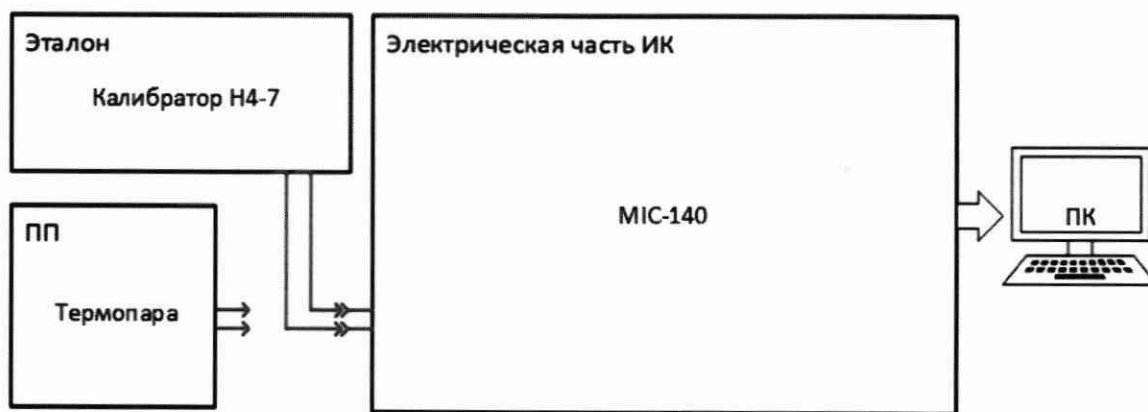
Рисунок 3 – Схема поверки ИК температуры жидких и газообразных сред (с ПП – термоэлектрическим преобразователем) поэлементным способом
