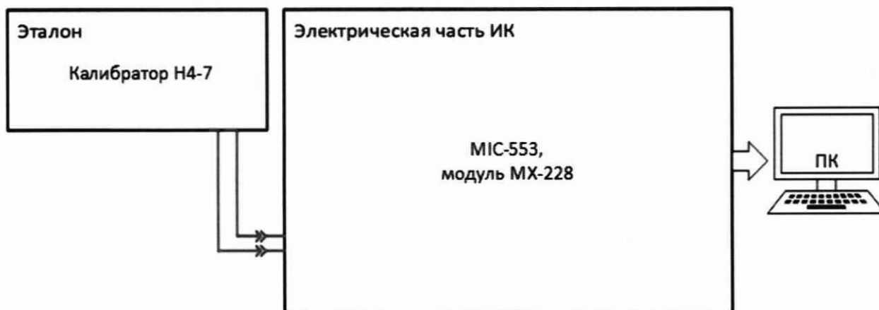
Рисунок 17 – Схема поверки ИК напряжения постоянного и переменного тока, соответствующего вибрациям и пульсациям давления
