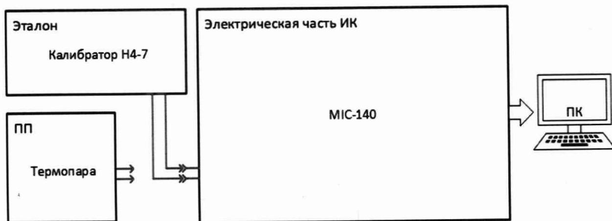
Рисунок 14 – Схема поверки ИК сигналов от датчиков температуры (ТЭДС термопар, соответствующих температуре)
