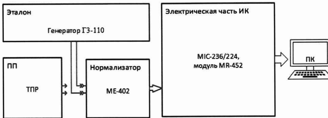
Рисунок 9 – Схема поверки ИК объемного расхода (прокачки) жидкостей
