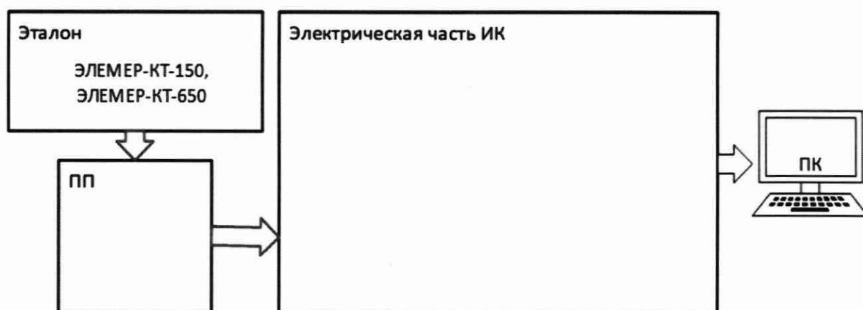
Рисунок 4 – Схема поверки ИК температуры жидких и газообразных сред комплектным способом
