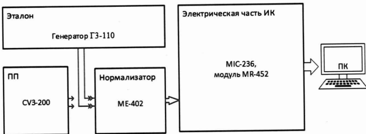
Рисунок 13 – Схема поверки ИК частоты переменного тока
