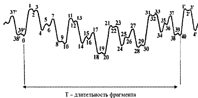
Рис. 12 – Форма испытательного ЭЭГ-сигнала «ЭЭГ-7»
