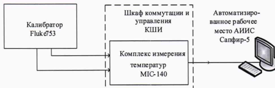
Рисунок 20 – Схема поверки ИК напряжения постоянного тока, соответствующего значениям температуры газообразных сред в диапазоне преобразований первичных преобразователей термоэлектрического типа ХА (К)
