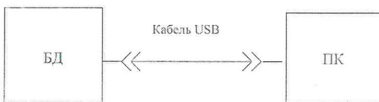
БД – блок детектирования гамма-излучения БДКГ-201М (БДКГ-203М, БДКГ-205М, БДКГ-211М, БДКГ-219М);
