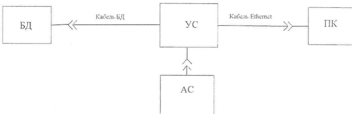
БД – блок детектирования гамма-излучения БДКГ-201М (БДКГ-203М, БДКГ-205М, БДКГ-211М, БДКГ-219М);
