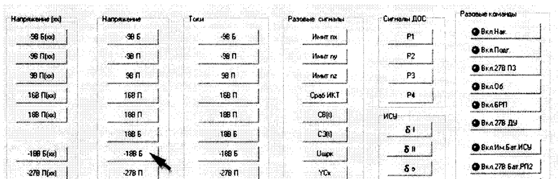
Рисунок 53 – Измерение напряжения по цепи «- 18 В Б»
