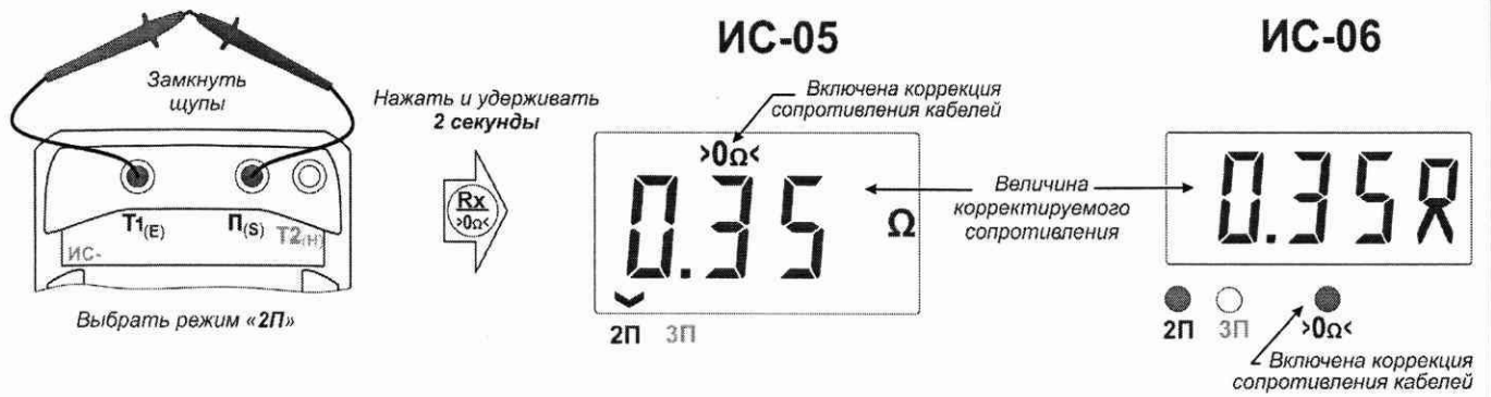
Рисунок 4 – Коррекция сопротивления измерительных кабелей (2П)
