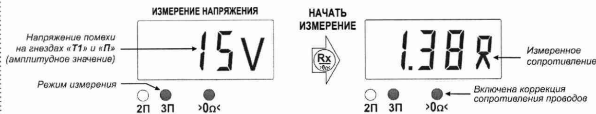
Рисунок 5 - Схема подключения и вид индикатора при измерении сопротивления заземления трёхпроводным методом
