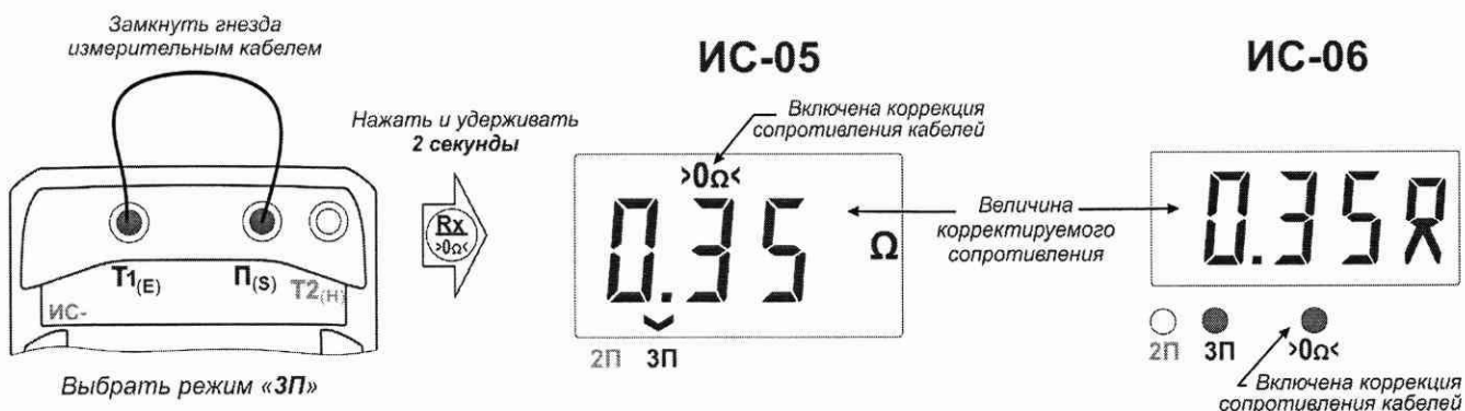
Рисунок 3 – Коррекция сопротивления измерительного кабеля (3П)
