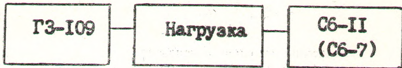
Рис. 8. Схема структурная соединения приборов для определения коэффициента гармоник выходного сигнала
