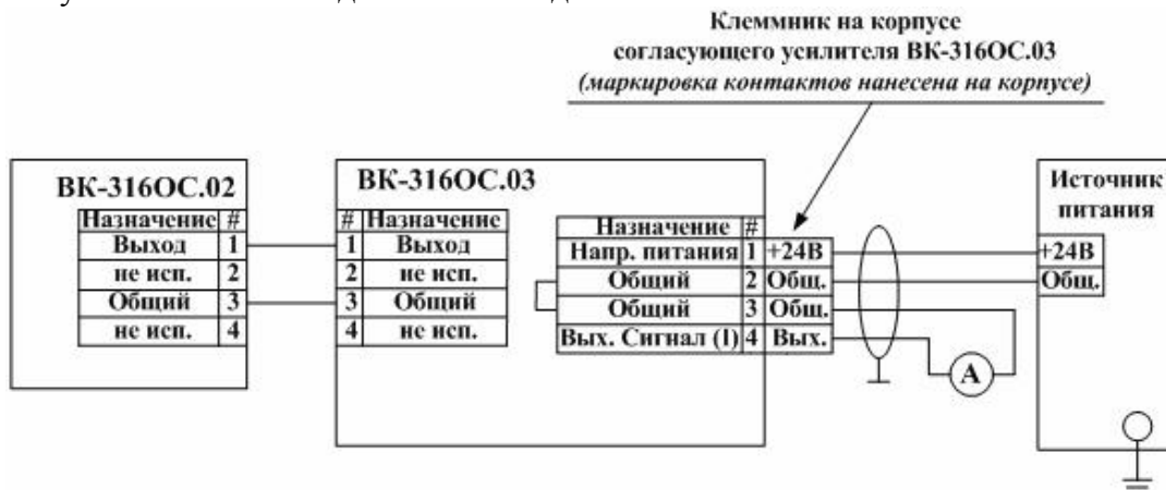
Рисунок 2в. Схема подключения модели ВК-316ОС.01.
