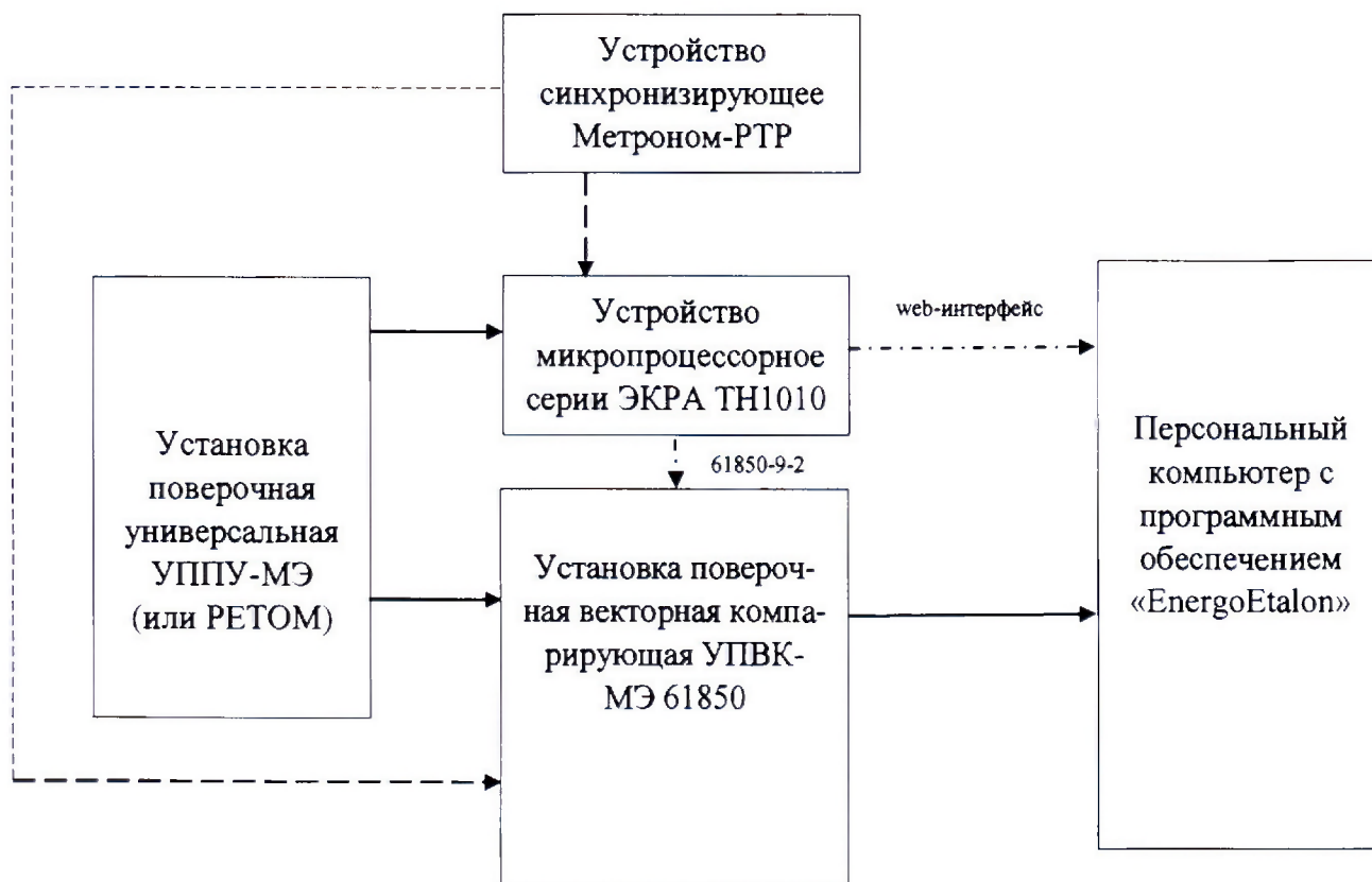
Рисунок А.1 – Схема структурная проверки погрешностей для испытательного сигнала до 10 А включительно
