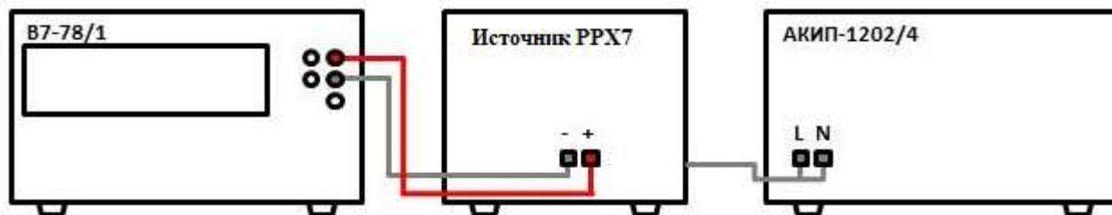
Рисунок 1 – Схема соединения приборов для определения погрешности установки/измерений напряжения постоянного тока
