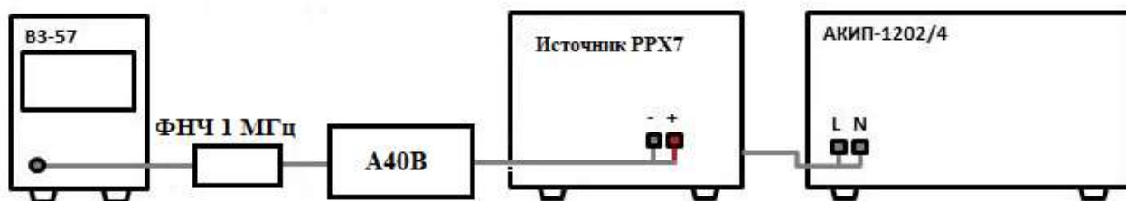
Рисунок 4 – Схема соединения приборов для определения уровня пульсаций выходного тока
