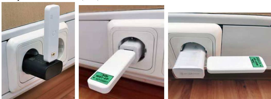
Рисунок 1.4 – Варианты подключения тегов WST-ETM к USB-розетке сетевого зарядного устройства
