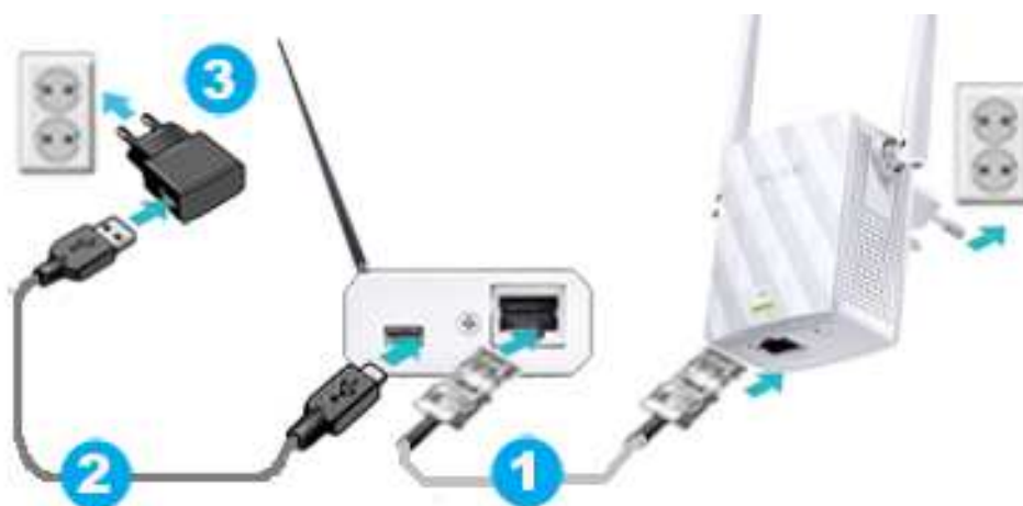
Рисунок 2.6 – Подключение менеджера WST-EMT к Интернету через беспроводной Wi-Fi-репитер
