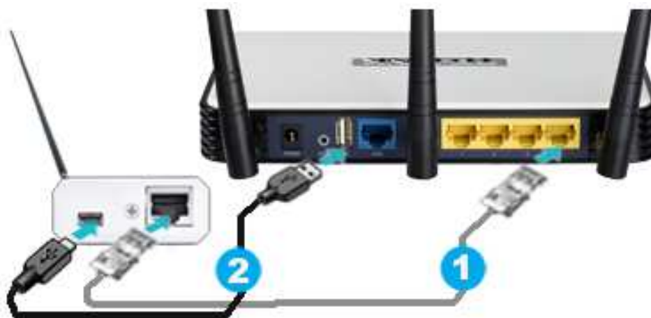
Рисунок 2.5 – Подключение менеджера WST-EMT к беспроводному Wi-Fi-Интернету
