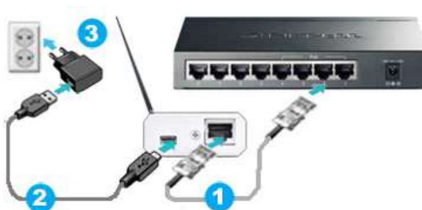
Рисунок 2.1 – Подключение менеджера WST-EMT к проводному Интернету.
