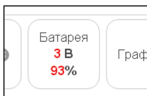
Рисунок 2.61 – Вид кнопки [Батарея] на панели тегов при низком напряжении питания.
