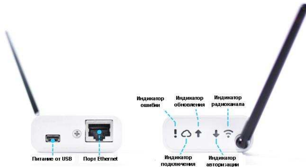
Рисунок 1.9 – Внешний вид и назначение разъёмов и светодиодных индикаторов менеджера тегов WST-ETM
