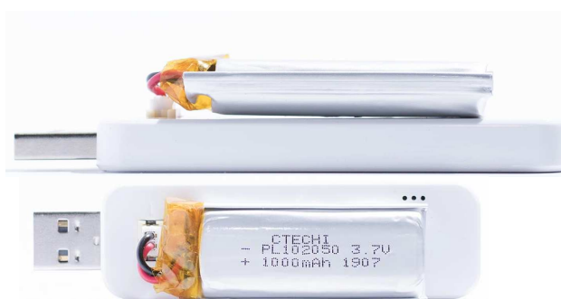
Рисунок 1.6 – Тег WST-ETM, оснащённый литиево-полимерным аккумулятором
