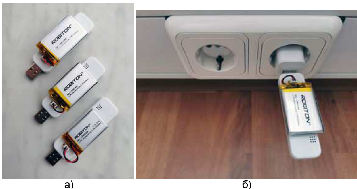
Рисунок 1.7 – (а) Теги WST-ETM, оснащённые литиево-полимерными аккумуляторами разной ёмкости. (б) Тег WST-ETM с литиево-полимерным аккумулятором, подключённый по варианту «подзарядка/резервное питание»
