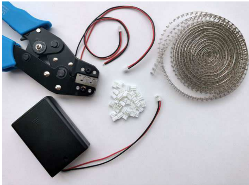
Рисунок 1.8 – Оснастка для подключения внешнего источника питания к тегу WST-ETM
