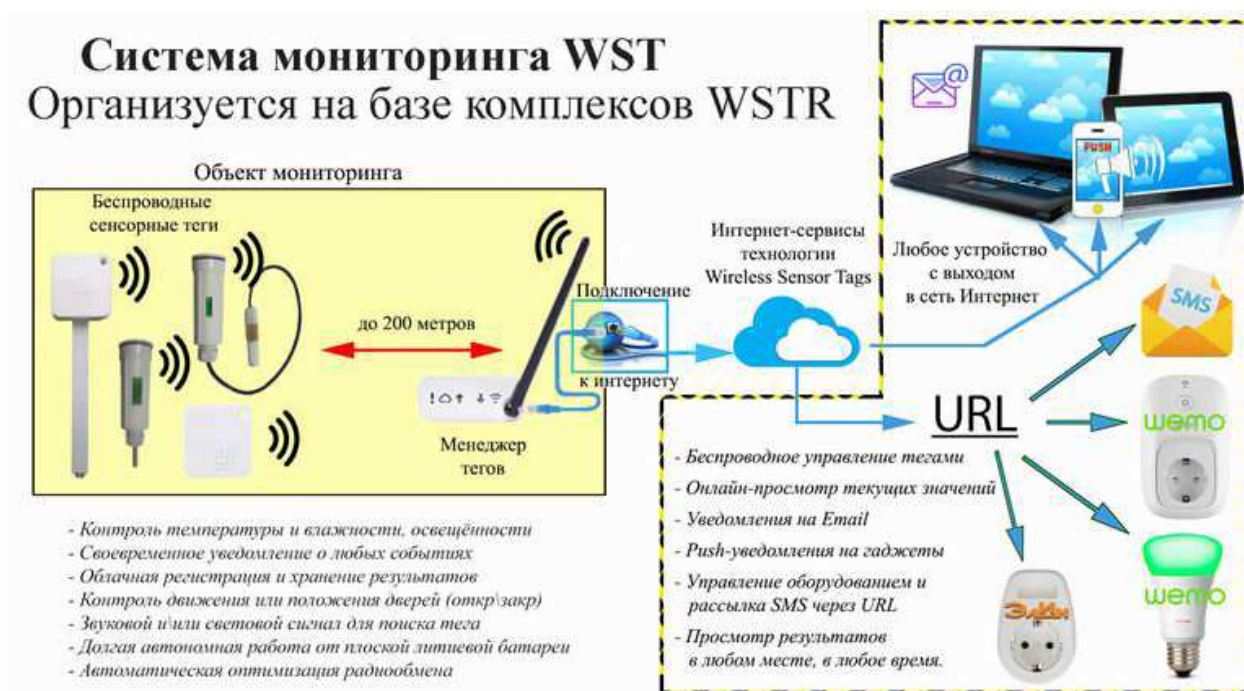
Рисунок 1.2 – Функциональная схема применения комплекса WSTR для организации распределённой системы мониторинга WST
