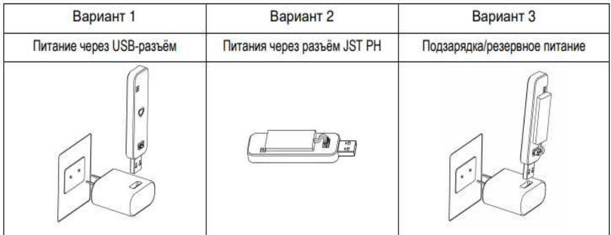
Рисунок 2.9 – Подключение источника внешнего питания
