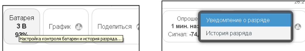
Рисунок 2.58 – Кнопка [Батарея] на панели тегов и меню настройки уведомлений о снижении напряжения внешнего источника питания тега и истории изменения напряжения внешнего источника питания.
