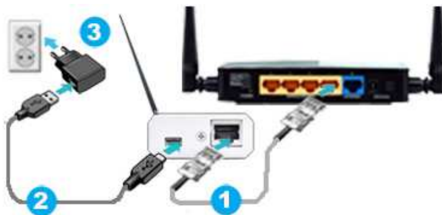
Рисунок 2.4 – Подключение менеджера WST-EMT к беспроводному Wi-Fi-Интернету
