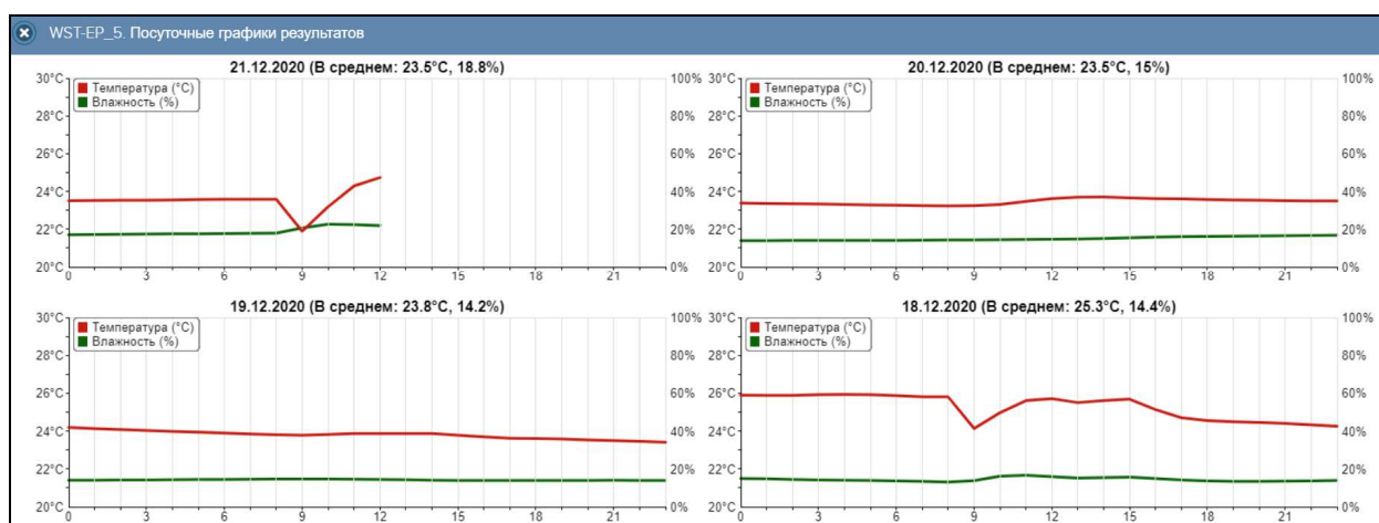
Рисунок 2.73 – Окно посуточных графиков температуры и влажности тегов.
