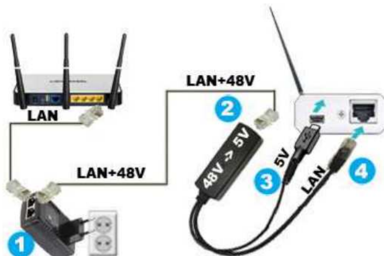
Рисунок 2.3 – Подключение менеджера WST-EMT к проводному интернету с использованием технологии POE
