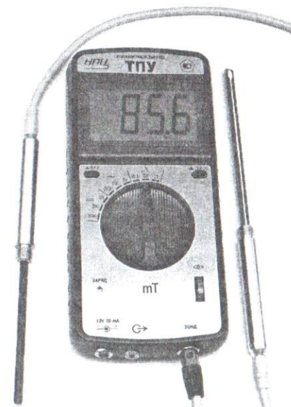
Рис. 1. Внешний вид миллитесламетра портативного универсального ТПУ
